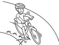
カーブで曲がる側のペダルを下げないでください。ペダルが地面と接触し、転倒によるけがのおそれがあります。
