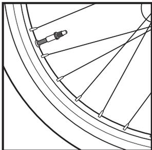
**タイヤ空気圧** 通常自転車のタイヤは時間とともに空気圧が低下します。
