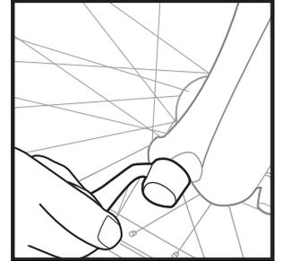
3. ハブの右側にある調整ナットを時計回りに回し、レバーを閉じるとき、レバーがハブの中心線と平行になる位置で抵抗を感じるようにします。
