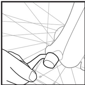
2. クイックリリースレバーの方向から見て、ハブの反対側にある調整ナットを、ナットとクイックリリースレバーがフォーク先端の脱落防止の出っ張りを越えるまで反時計回りに回します。
