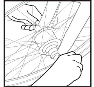
4. 左手でフォークをしっかりと握り、レバーが閉じるまでフロントフォーク側に押しします。正しく調整されたレバーを閉じるために必要な力の目安は、手のひらにレバーの跡がつく程度が適切です。閉じた状態では、レバーの「OPEN」の表示が見えなくなります。十分な力で閉じられたレバーは、逆の手順で再び開かない限り簡単には開きません。簡単に開いてしまう場合は、レバーを開いて調整ナットを180°締め込み、レバーを閉じて確認してください。それでも正しく閉じられない場合は、さらに調整ナットを調整してください。
