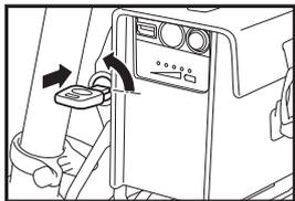
1. バッテリーロックのキーを差し込み、押しながら反時計方向に回してロックを解除します。
