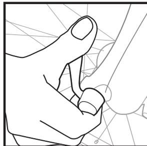
**クイックリリース** 前輪には脱着を容易に出来るクイックリリース機能を備えています。前輪のクイックリリースが正しく調整され、緩みがないことを確認してください。
