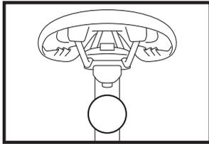
**リフレクター** 本製品にはリフレクターが装備されており、夜間の被視認性を高めています。毎回の走行前に、リフレクターが正しい向きで確実に取り付けられており、破損や汚れがないことを確認してください。
