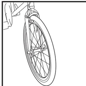
2. クイックリリースレバーを開いた状態（レバーの曲がり方がハブから離れる方向になっている状態）にして、アクスルがフォークエンドの奥に入るように車輪をフロントフォークにセットします。
