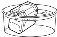
バッテリーを水没させないでください。異常発熱、発火、破裂のおそれがあります。
