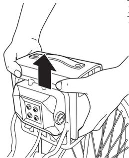
バッテリーを外す際は、イラストのように親指をバッテリーのステー側に掛け、その他の指をバッテリー底部で支えて、上にスライドするように外してください。
