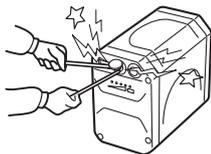
バッテリーの接続端子を、金属などでショートさせないでください。液漏れ、異常発熱、破裂の原因や感電のおそれがあります。
