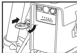
1. バッテリーロックのキーを差し込み、ロックが解除された状態にします。
