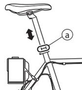
シートポストの、差し込み限界マーク①が見える状態で乗らないでください。シートポストの破損や、転倒によるけがのおそれがあります。
